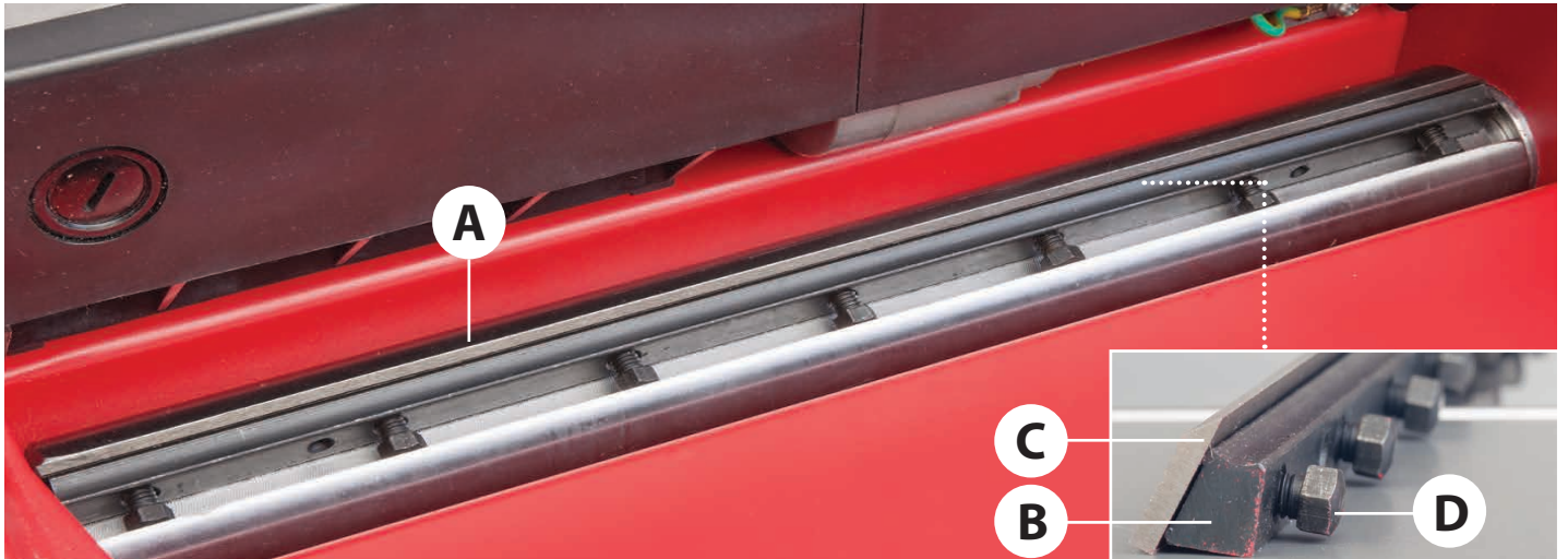
Cutter block (A), Blade holder (B), Blade (C), Square nut (D)
