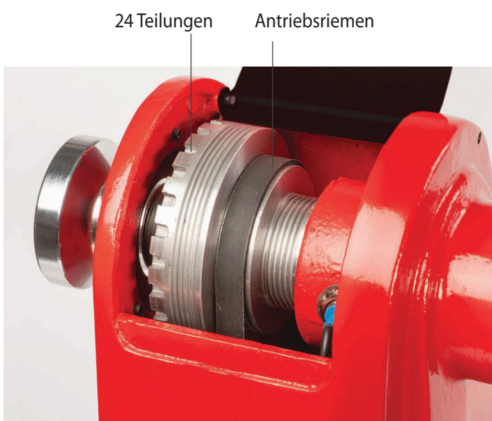
Spindelriemenscheibe mit 24-facher Teilung
