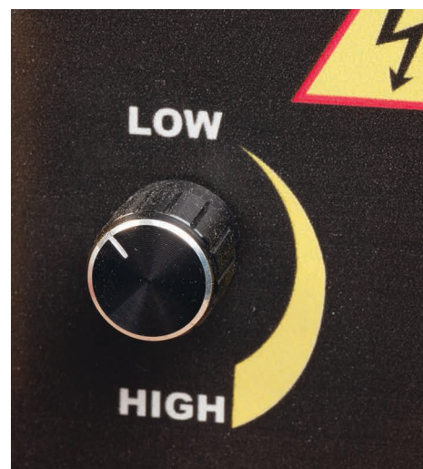
Bouton de commande de la vitesse variable 250 - 3 550 tr/min
