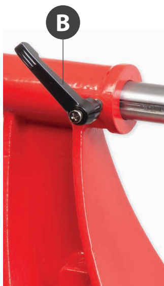
Manette de la contre-poupée (A), blocage du fourreau de la contre-poupée (B), Blocage de la manette de la contre-poupée (C)
