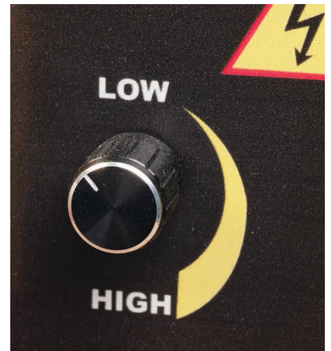
Variable Drehzahlregelung 250-3.550 U/min
