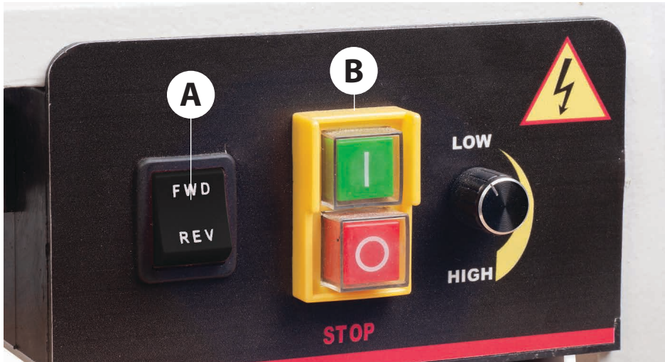
Vorwärts/Rückwärts-Schalter zum Ändern der Spindelrichtung (A) (Schalter NICHT betätigen, wenn die Drehbank in Bewegung ist) EIN/AUS NVR-Schalter (B)
