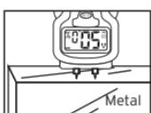
Ölçüm ucu metal ya da – iletken yüzeylere konumlandırılır ise, göstergede maximum değeri olan »50« ya da »33« görünür.
