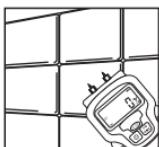
**Kontrola zawartości wilgoci w materiałach budowlanych,** jak np. w betonie, cegłach, jastrychu, kartonach gipsowych, tapetach przed ich dalszą obróbką.
