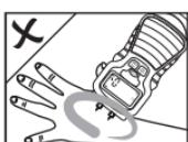
Manipulez l'appareil avec précaution quand le couvercle de protection est retiré. Les pointes de mesure peuvent entraîner des blessures en cas d'utilisation incorrecte.
